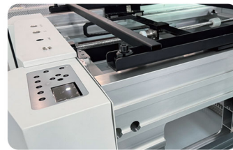
โครงสร้างอลูมิเนียมแบบรวม เพิ่มความแข็งแรง ลดน้ำหนัก
